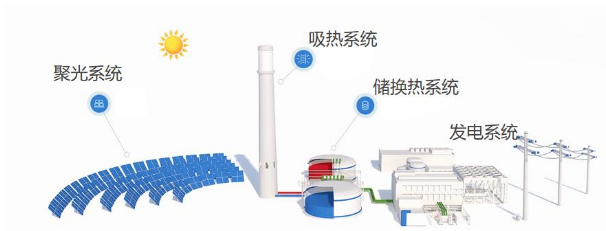
图 1 塔式太阳能热发电流程图
