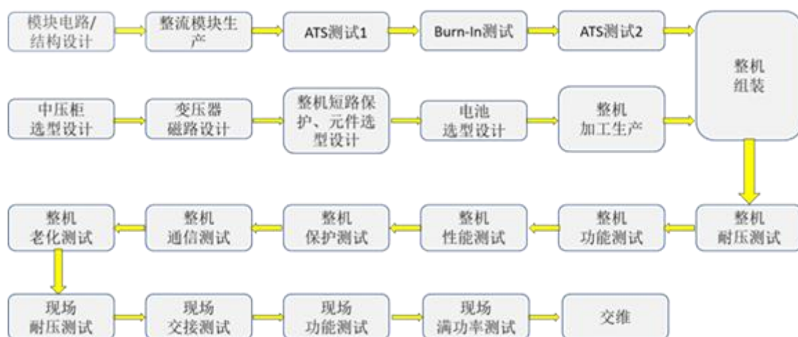
图 1 10kV 交流输入的直流不间断电源工艺流程图
