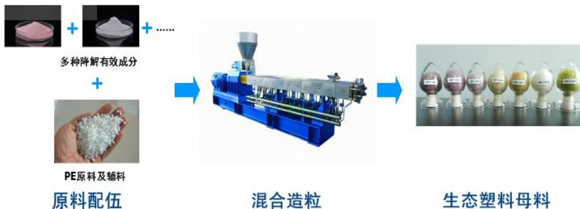
图1 纳米高分子复合型生态塑料母料制备流程
